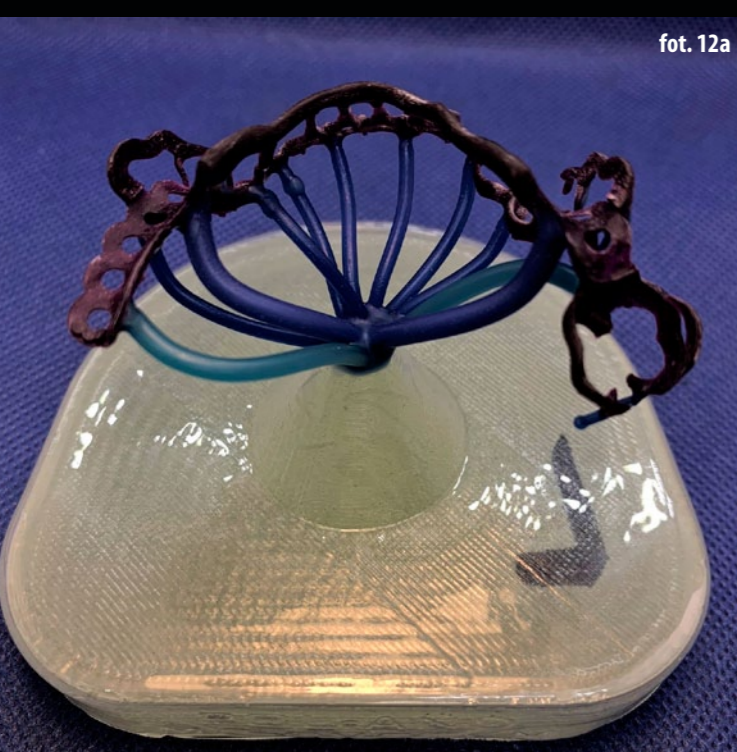
▼ fot. 12a i 12b. Struktura z wklejonymi kanałami odlewowymi przyklejona do podstawki
