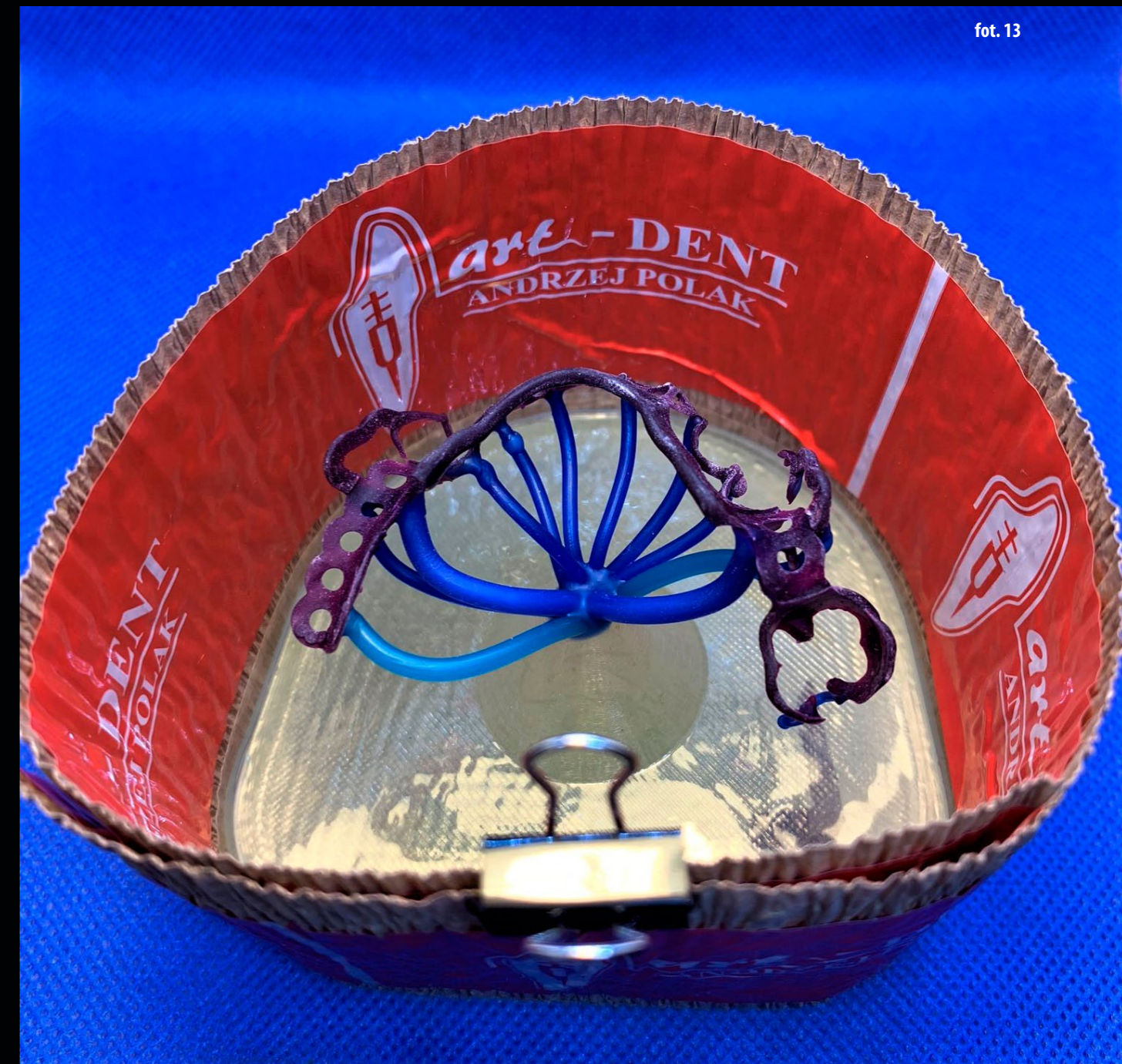
▲ fot. 13. Konstrukcja przygotowana do zalania masą osłaniającą (Pol-And Model Cast System)
